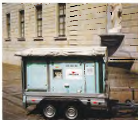
Der schallgedämmte Hochdruckreiniger KR 300 mit Druck bis zu 300 bar und einer Temperatur bis 150 Grad.
