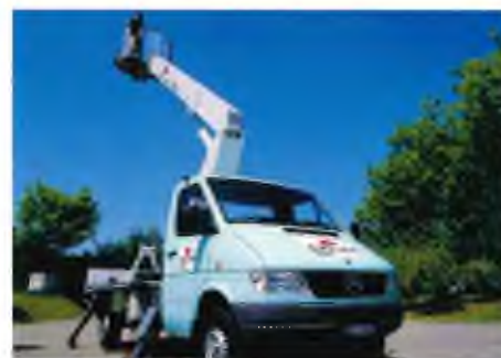
Einer unserer Sky-Lifte für eine Arbeitshöhe bis 23 Meter.
